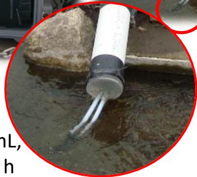
Dos sensores disparan el muestreo al contactar el agua de la crecida
